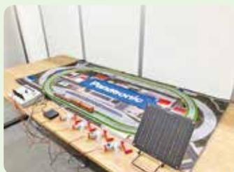
手回し発電機で発電した電気で鉄道模型を走らせます。
