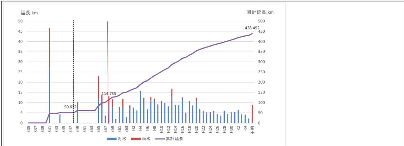
公共下水道事業は、事業認可区域で下水道が未整備の区域について整備を進めていきます。本市の管路総延長は令和5(2023)年度末で約438kmとなっています。内訳は汚水管が約358km、雨水管が約80kmです。このうち、令和5(2023)年度を基準年とした場合に経過年数が50年以上となる管路は約48km(全延長の約11%)であり、汚水管で約31km、雨水管で約17kmとなっています。改築を実施しない場合、10年後には経過年数が50年以上となる管路は約115kmとなります。
