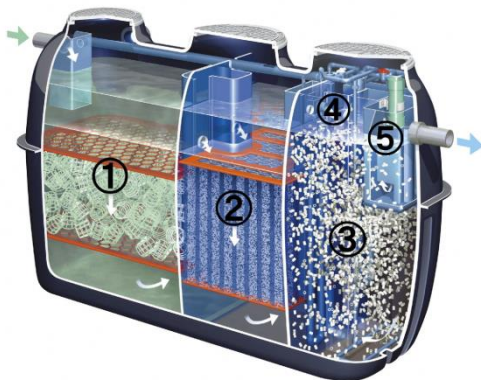
図- 23 浄化槽の模式図
