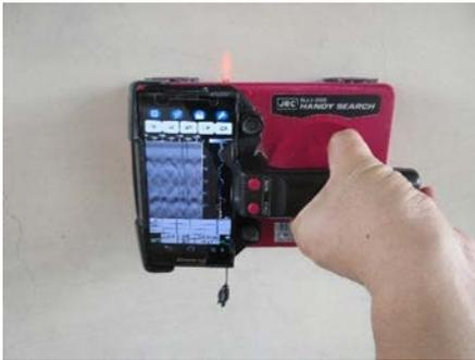
電磁波レーダ法による配筋探査
