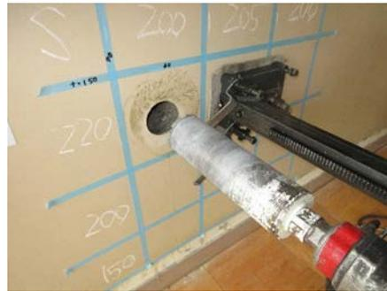
コンクリートコア試験体の穿孔採取
