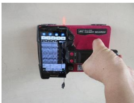
電磁波レーダ法による配筋探査
